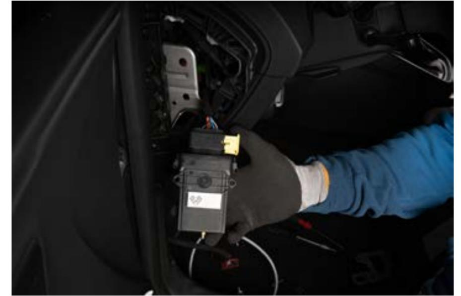
Verbinden Sie die VCU mit dem schwarz gelben Stecker. Die gelbe Verriegelung muss komplett eingeschoben werden.
