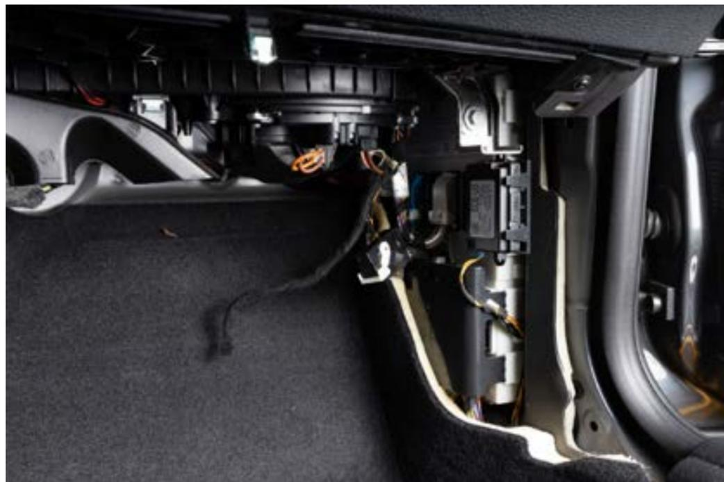
Lösen Sie den schwarzen Stecker. Eventuell muss der darüberliegende schwarze Haltebügel vorab demontiert werden. Ziehen Sie die beiden Steckerblöcke aus dem schwarzen Stecker heraus. Lösen Sie dafür die seitliche Haltenase am Steckergehäuse.
