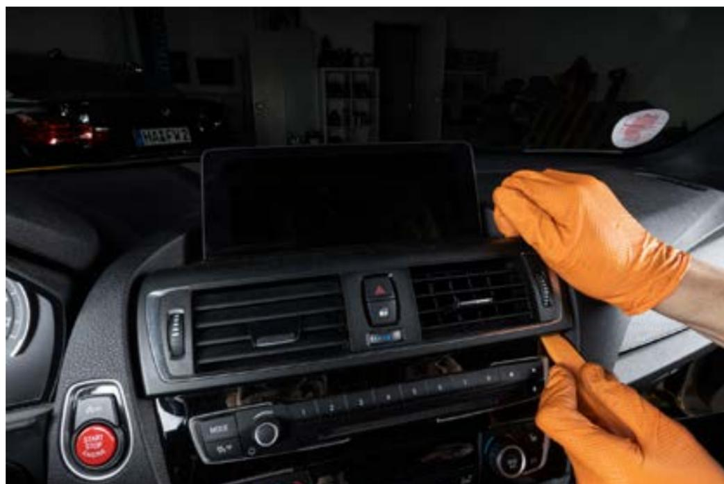
Hebeln Sie mit Hilfe des Kunststoffwerkzeuges die Verkleidung heraus. Hebeln Sie vorsichtig an beiden Seiten der Blende.
