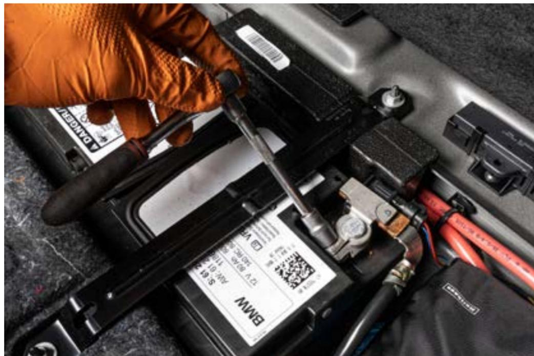
Klemmen Sie die Fahrzeugbatterie über das Massekabel ab.
