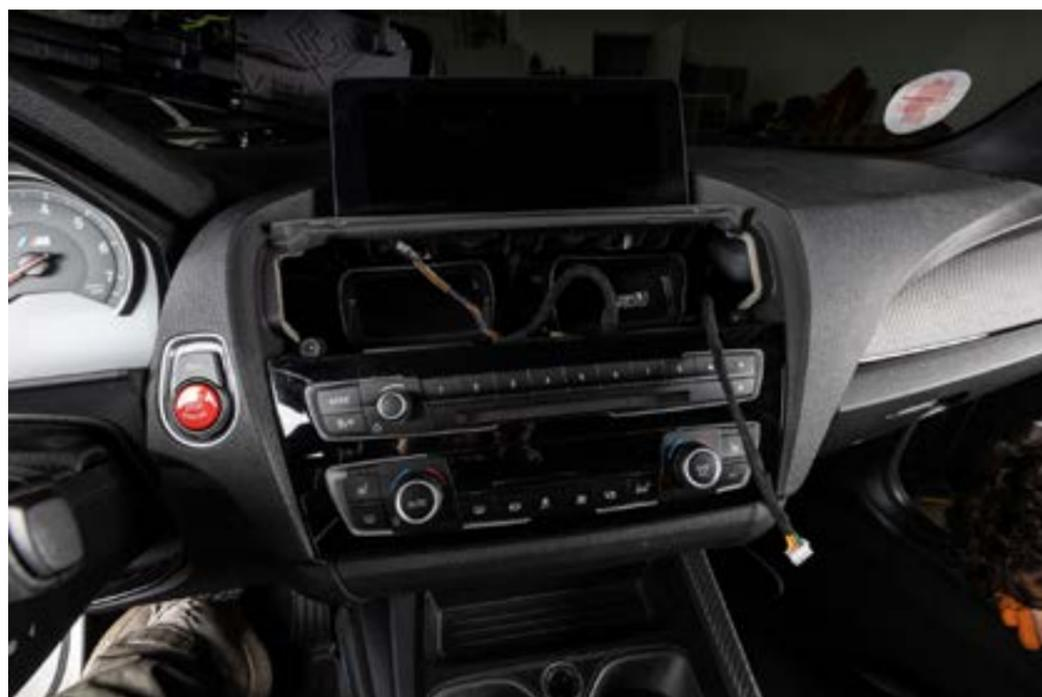
Verlegen Sie den Vektor Kabelbaum vom Beifahrer Fußraum aus in die Mittelkonsole. Das 4-polige Kabel samt Stecker muss oben ein Stück herauschauen. Siehe Bild.
