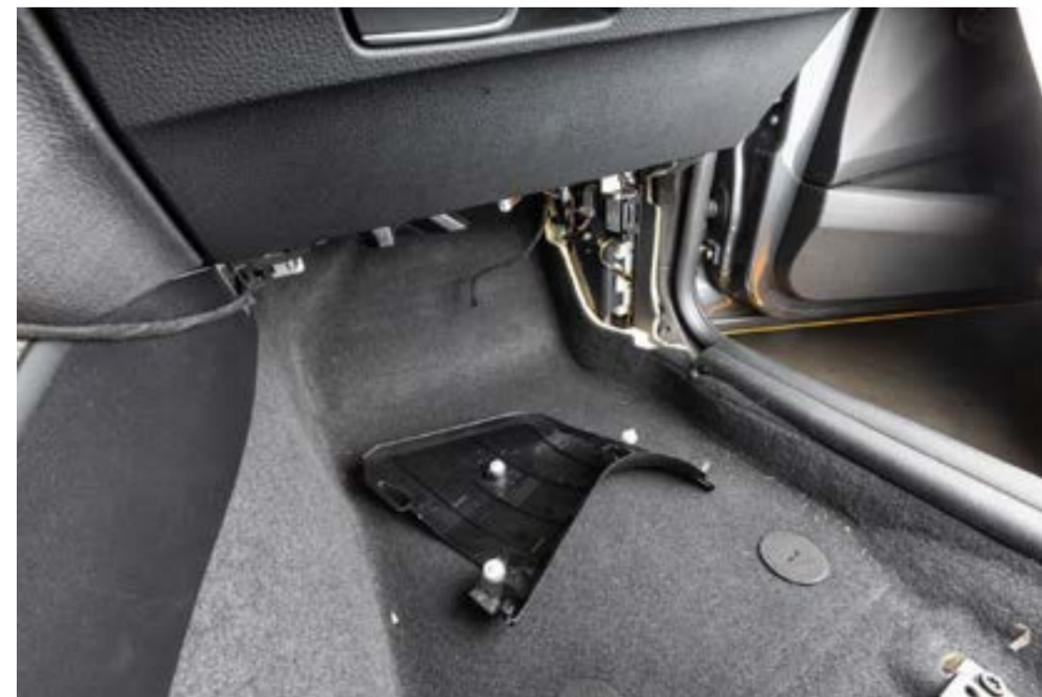
Demontieren Sie die rechte Abdeckung des Beifahrer Fußraums. Dahinter befindet sich ein Steuergerät.
