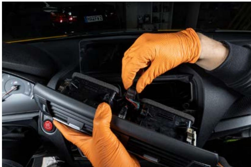
Lösen Sie die Steckverbindungen.
