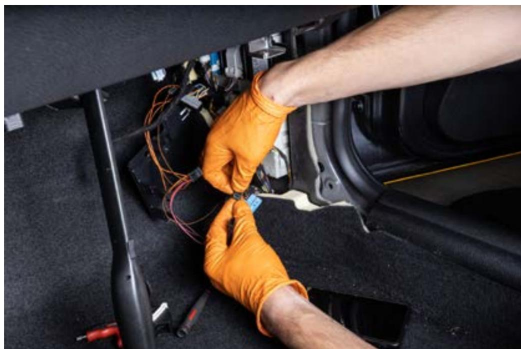
Setzen Sie jetzt die losen Pins aus dem Fahrzeugkabelbaum in den entsprechenden Adapter des Vektor Kabelbaums ein. Folgen Sie den Kabeln der jeweiligen Pin Position des 4-poligen Steckers zum jeweiligen Steckplatz - wie auf der vorherigen Seite beschrieben.
