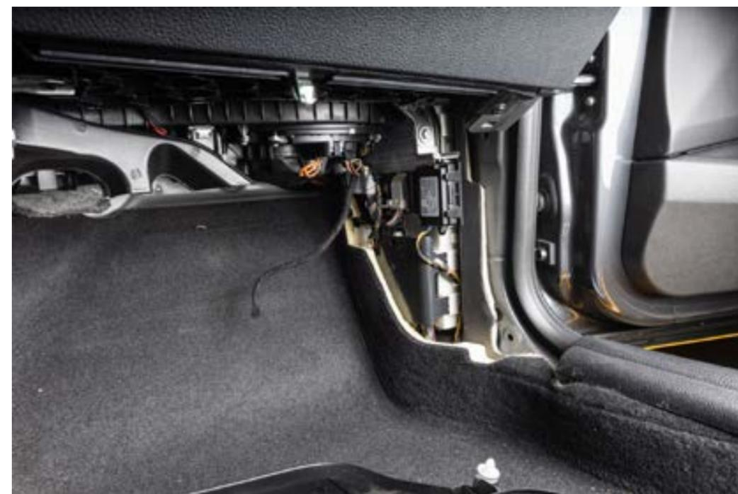
Demontieren Sie auch die Abdeckung unterhalb des Handschuhfaches. Verlegen Sie den Kabelbaum hinter dem Fahrzeugteppich.
