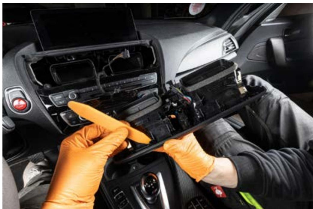
Hebeln Sie mithilfe des Kunststoffwerkzeuges den Ausströmer aus der Blende. Vorsichtig: die Kunststoffnasen neigen zu brechen.
