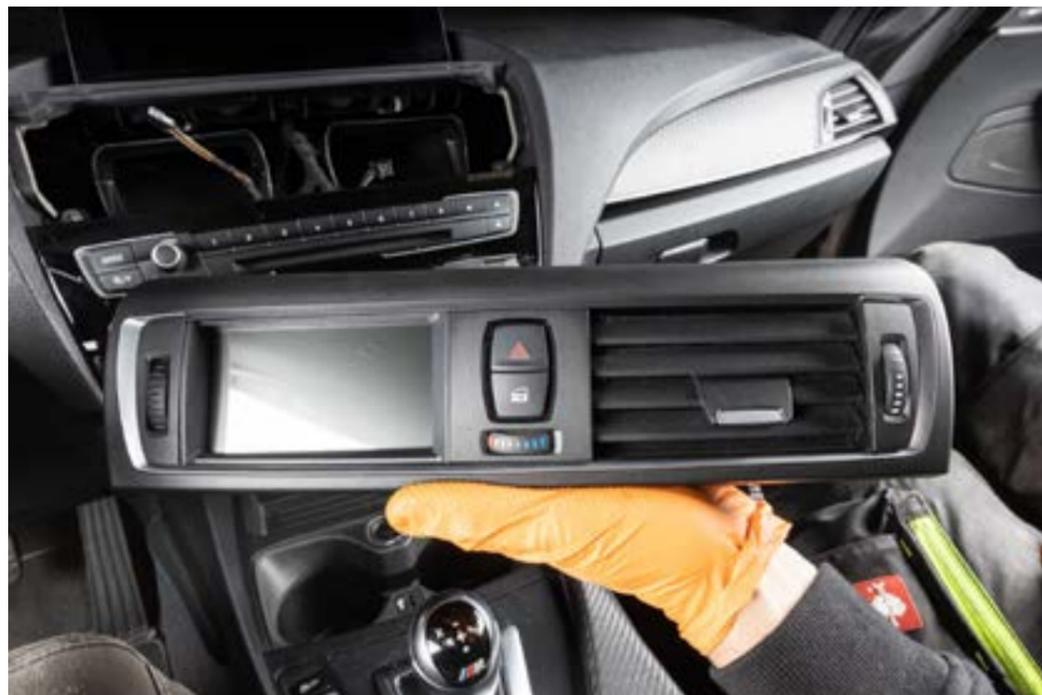
Setzen Sie das Display samt Ausströmer in die Blende ein. Halten Sie den Bereich des Klebestreifens für eine Minute gedrückt.
