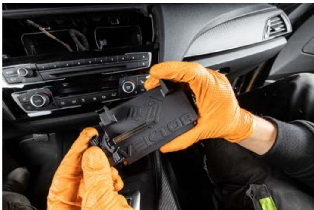
Setzen Sie den Sensor in der Vektor Blende ein und sichern ihn durch verdrehen.
