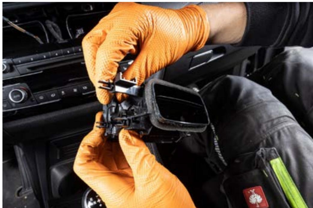
Lösen Sie durch drehen den Sensor aus dem originalen Ausströmer und ziehen ihn heraus.
