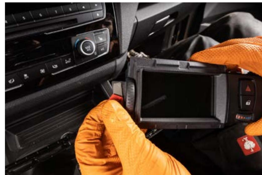
Lösen Sie den Klebestreifen auf der Vektor Blende.
