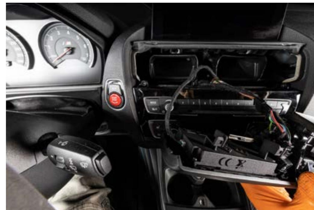
Schließen Sie den Kabelbaum am Display an und setzen es ein.
